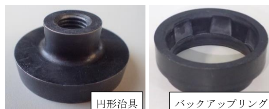
Fig. 1 円形治具とバックアップリング Circle fixture and masking tool for circle fixture
